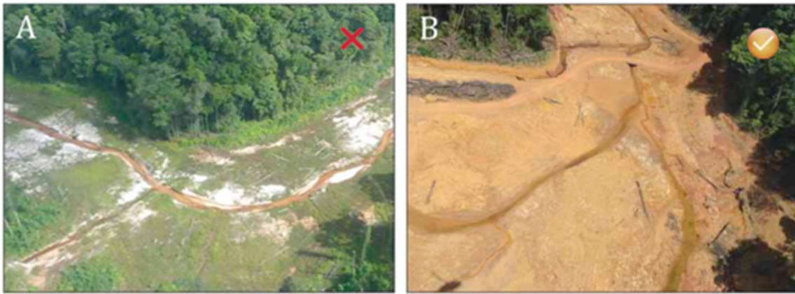
Figure 3. Exemple de confluences réhabilitées : (A) la confluence est trop perpendiculaire (et l'affluent est par ailleurs trop rectiligne). (B) L'angle de la confluence est correct (l'ouvrage de franchissement en aval immédiat de la confluence semble cependant sous-dimensionné).
